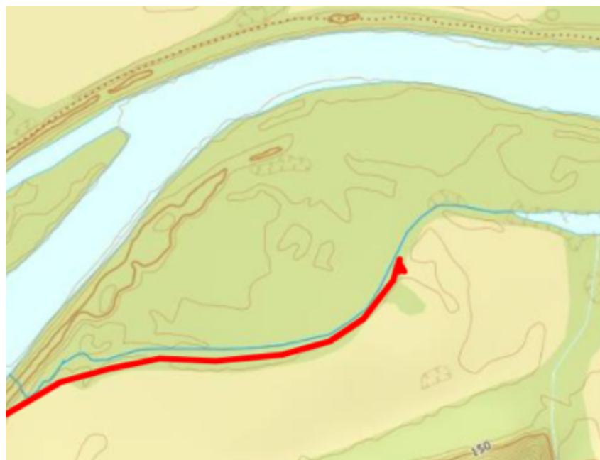
Figur 14: Rød strek er ny flomvoll, lengden på flomvollen vil avhenge av hvor langt massene fra den gamle flomvollen rekker.
