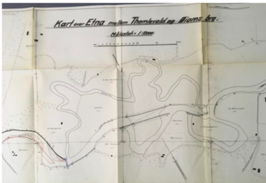
Figur 6: Del av kartgrunnlaget for gjennomstikket / kanaliseringen forbi meanderne ved Øiom, her hadde elva to løp, rester av begge løpene finnes fortsatt. Fra Zinke (2021), (NVE-arkiv Hamar, A4977).
