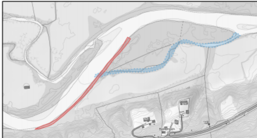
Figur 13: Etna ved Bjørnmoen. Kartet viser forbygning (rød markering) og tidligere flomløp (blå markering)
