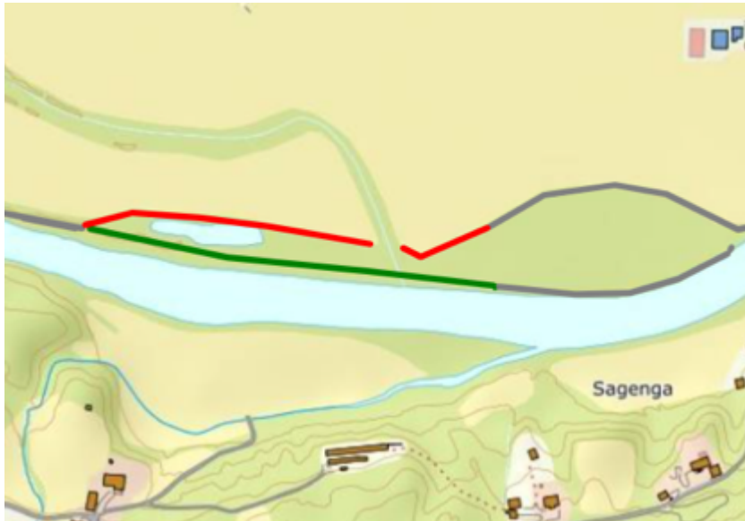
Figur 21: Rødt er ny flomvoll, grønn er sanert flomvoll og grå er eksisterende flomvoll (Fra gårdskart).
