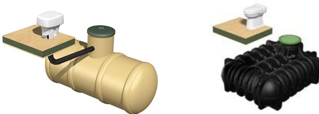
Figur 10: Prinsippskisser av samletanker for toalettavløp
