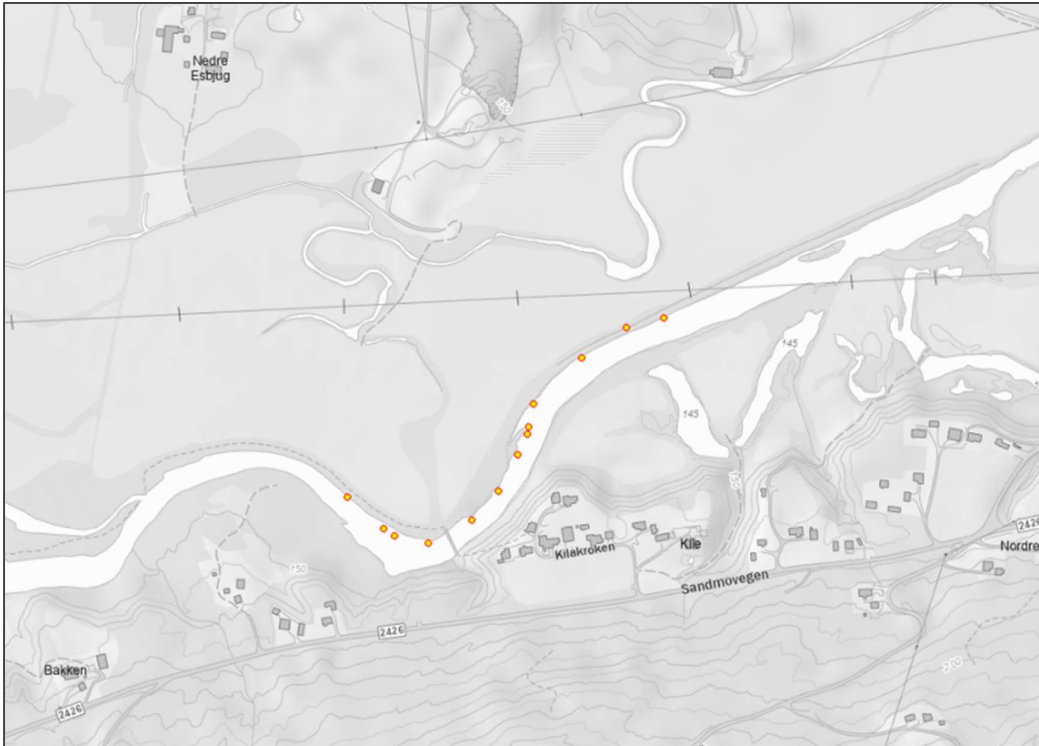
Figur 2-4. Vannlinjemålinger benyttet for kalibrering av modell ved 13,6 m 3 /s, for en kort strekning mellom Bakken og Øyom.
