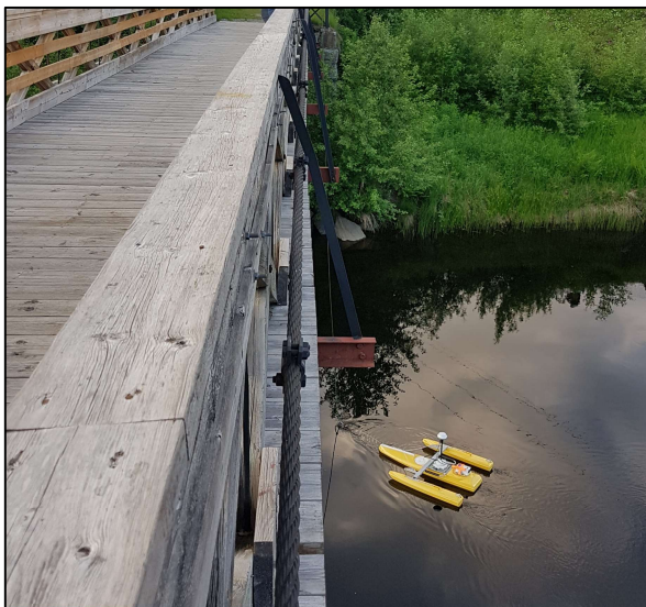
Figur 2-1. Bilde fra gangbrua og trimaranen som ble benyttet for å trekke ADCP over elva.
