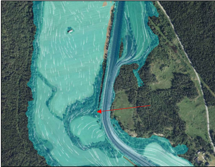
Figur 6-2. Ved en 200-årsflom vil vannstanden i elva flere steder være høyere enn flomvollene, noe som gjør at vannet går over vollene og oversvømmer flomsletta.
