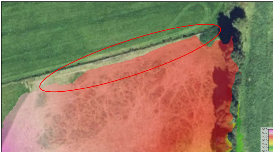
Figur 5-5. Sammenligning av observert og beregnet vannlinje for venstre side av elva ved vannføring Q = 195 \text{ m}^3/\text{s} .
