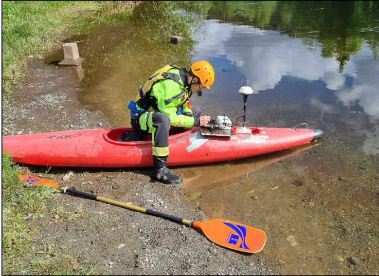
Figur 2-5. Kajakk som ble benyttet til å feste ADCP for bunnkartlegging/måling av vanndybder.
