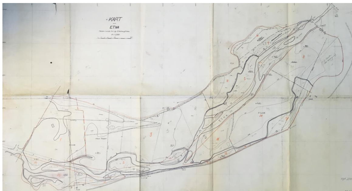
Figur 4.8: Kartgrunnlag fra 1934 (NVE/F 22458) med manuell inntegning av planlagte kanaliserings- og forbygningsplaner fra 1950-tallet på delstrekning mellom Lunde bru og Ruse (NVE-arkiv nr. A4977).
