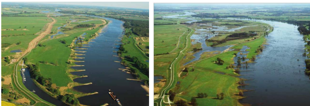
Figur 5.10: Flytting av flomvoller lange elva Elbe i Tyskland, under anleggsperioden (venstre) og under flom etter gjennomføring av tiltakene (høyre). Fra BAW (2013).
