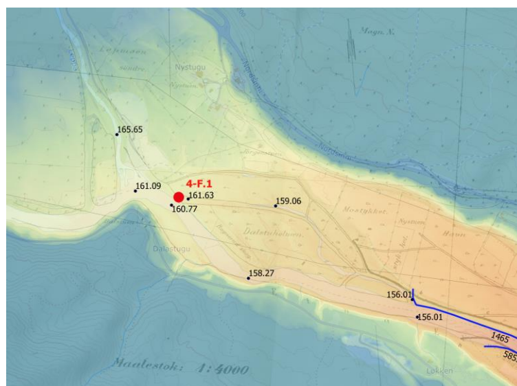
Figur 4.35: Tiltak ved utløp Leppa med terrengmodell, historisk kart fra 1904, registrerte sikringstiltak og utvalgte høydekoter.
