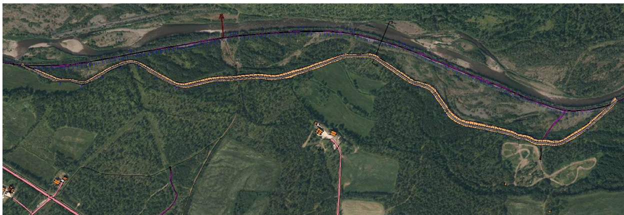
Figur 5.2: Prosjektert ny flomvoll plassert på ortofoto fra 2018. Fra NVE (2019).
