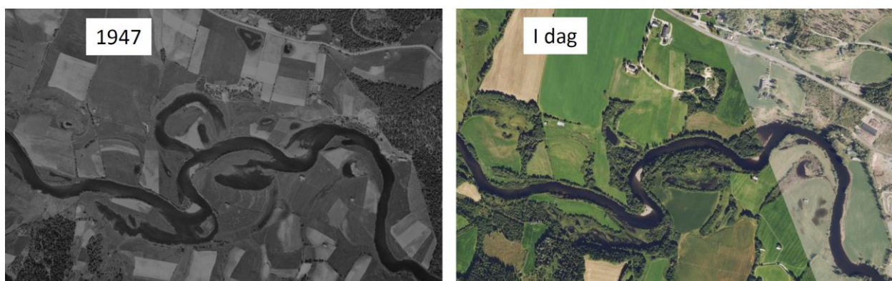
Figur 4.38: Flyfoto ved Roste-Ulvasvea fra 1947 og 2016/2017 som viser reduksjon av kroksjøer og dammer og endringer på flommarksvegetasjon.
