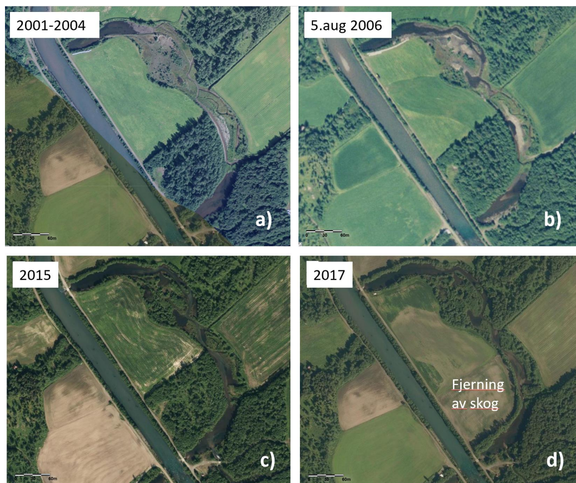
Figur 5.6: Gjenåpning av gamle meandere ved Salangelva. Flyfotoene fra norgebilder.no viser tilstanden før tiltaket (a), i året da tiltakene ble gjennomført (b), og noen år senere (c,d), med fjerning av skog mellom 2015 og 2017.
