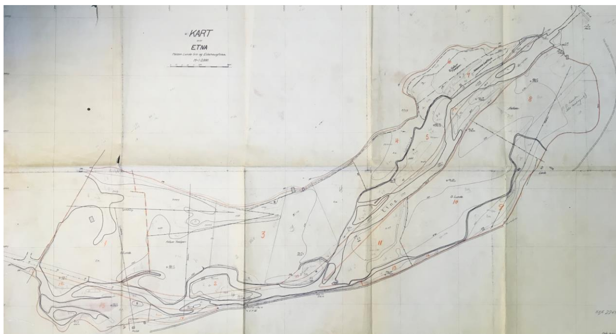
Figur V.3-1: Kartgrunnlag fra 1934 (NVE/F 22458) med manuell inntegning av planlagte kanaliserings- og forbygningsplaner fra 1950-tallet i delområde I mellom Lunde bru og Ruse (NVE-arkiv Hamar, nr. A4977).
