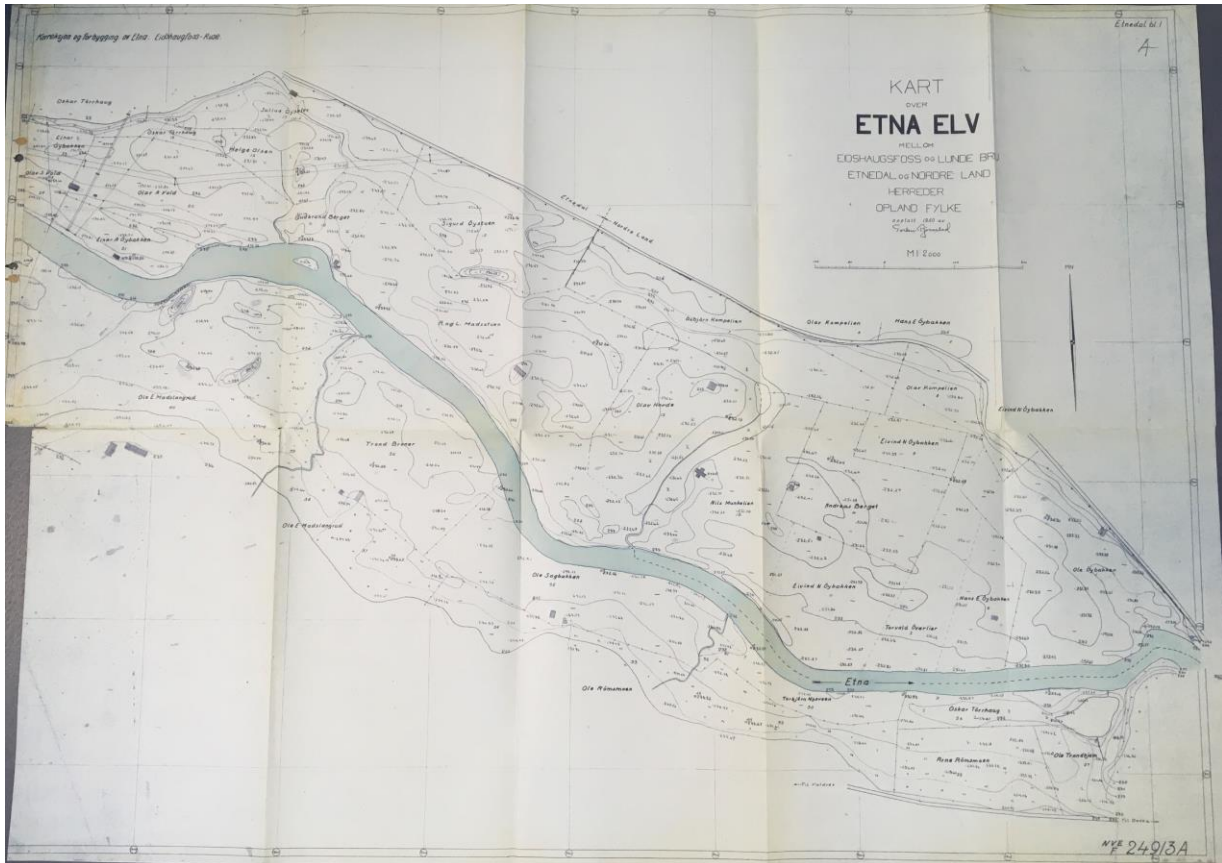
Figur V.3-4: Kartgrunnlag fra 1950 (NVE/F 249/3A) med kanaliserings- og forbygningsplaner fra 1950-tallet i delområde I mellom ndf. Madslangrud bru og Eidshaugfoss (NVE-arkiv Hamar, nr. A4977).
