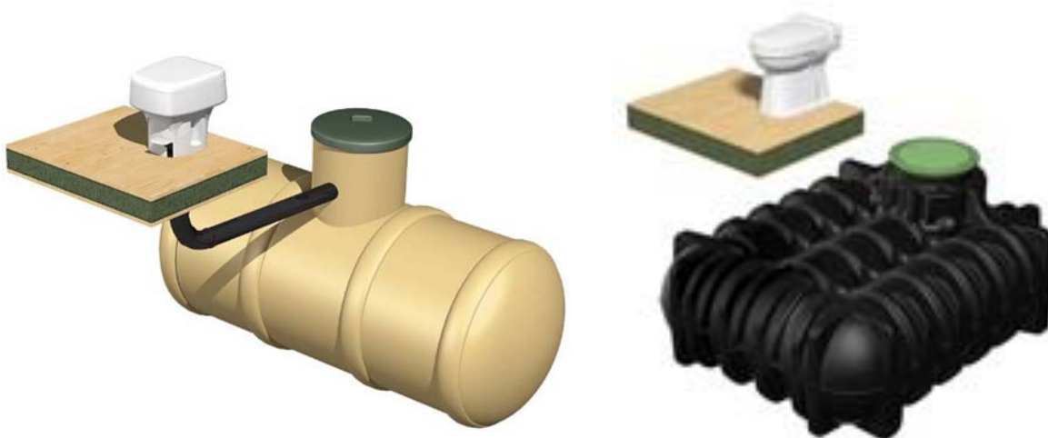
Figur 10: Prinsippskisser av samletanker for toalettavløp
