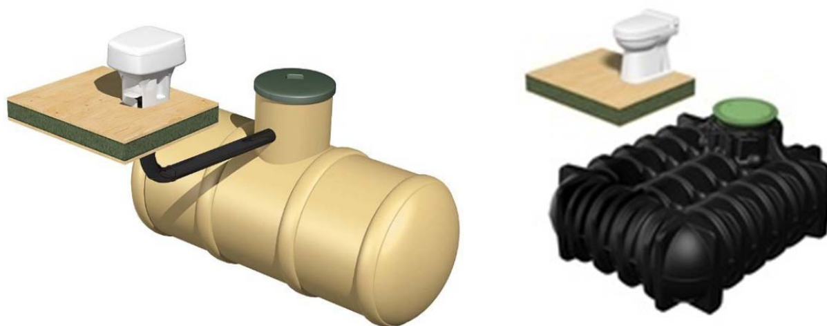
Figur 2: Prinsippskisser av samletanker for toalettavløp
